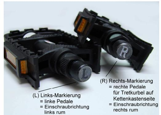
Damit das Gewinde nicht beschädigt wird müssen die ersten Gewingegänge ohne Werkzeug (immer in Fahrtrichtung) eingeschraubt werden. Mit einem 15-mm Gabenschlüssel können Sie danach die Pedale in den Kurbeln fest anziehen (entsprechend der Technischen Daten: 30 Nm).
